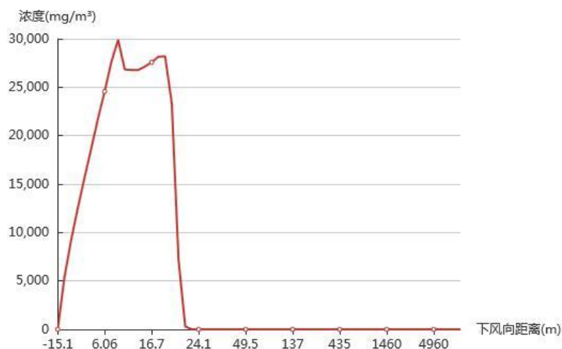
图 3.3.1-3 最不利气象条件下二甲醚下风向轴线最大浓度—距离曲线图
